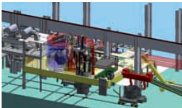
为阿赛洛米塔尔不来梅公司提供的双工位钢包炉三维示意图
