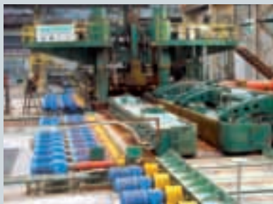
采用西门子奥钢联技术改造的可逆式开坯机
