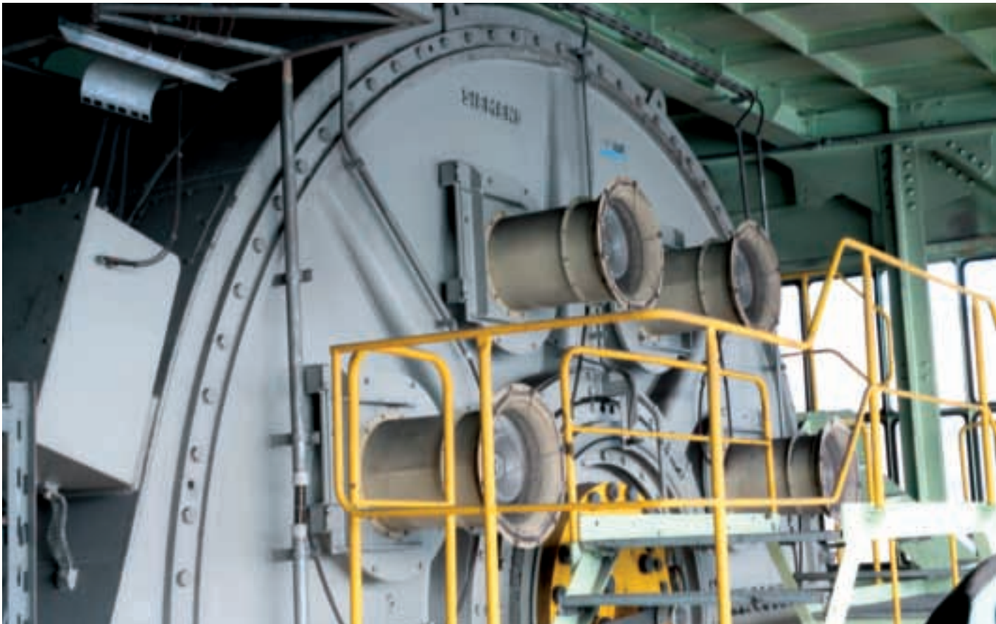
Vattenfall矿业公司12台铲斗链挖掘机上安装了额定能力为2 x 1,900 kW的西门子直接传动
