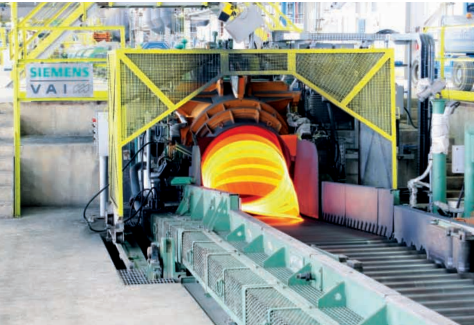
带尾圈控制功能的摩根高速吐丝机
